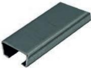
Länge: 2000 mm, Breite: 35 mm. Schlitzbreite 16,5 mm. Für die Verwendung als Träger zur Kabel- oder Rohrführung. Geeignet für die Verwendung mit der Bügelschelle (Hammerkopffuß).
