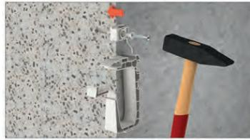
Einfaches Fixieren des Dübels durch den frei aufliegenden Satelliten. Der Sammler dient beim Fixieren als Handwerkzeug.
